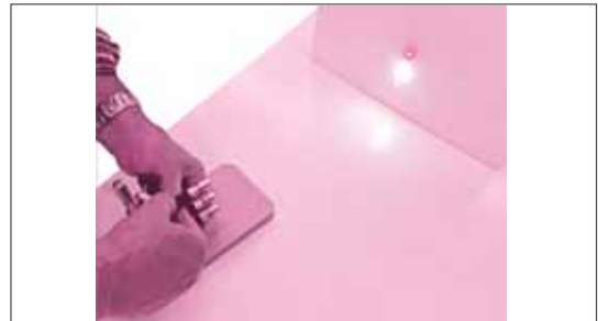
▲ شکل ۳. از تصویر سه لکه رنگی در یک خط مستقیم قائم روی پرده استفاده می‌شود تا درستی در کنار یکدیگر قرار گرفتن سه لیزر در یک خط قائم بررسی شود.
