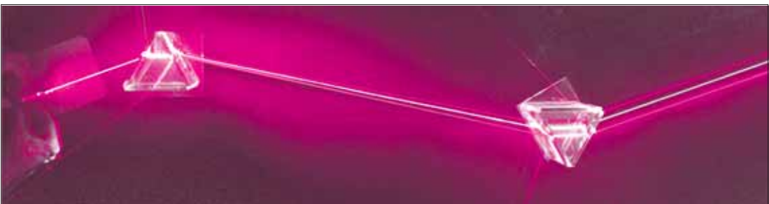
▲ شکل ۵. پرتو نور سفید که از طرف چپ وارد منشور می‌شود، واقعاً از سه پرتو مختلف ساخته شده است (هر کدام از نشانگرهای مختلفی هستند که به‌طور عمودی در کنار یکدیگر قرار گرفته‌اند). هر رنگ به‌صورت متفاوتی به وسیله منشور اول منحرف می‌شود، اما هنگام ترک منشور دوم به‌طور موازی بیرون می‌آیند.
